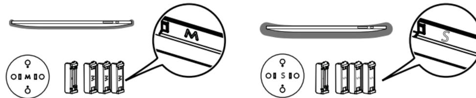
**Optionnel :** En cas d'utilisation de l'iPad avec un étui, retirer la grande griffe et les coussinets centraux, puis insérer les coussinets moyens dans le socle.
