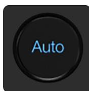
**Botón Auto Gain** - Cuando se selecciona un canal, pulse el botón Ganancia automática (Auto Gain) para que el Quantum ES ajuste automáticamente el nivel de ganancia del canal seleccionado ([para más información sobre la ganancia automática, consulte la sección 5.3](#)). La ganancia automática sólo está disponible para las entradas de micrófono y guitarra (no para las señales de nivel de línea).
