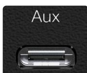
**Conector de alimentación auxiliar (USB-C)** - Cuando el dispositivo al que está conectado no proporciona suficiente alimentación a través de USB-C, se requiere alimentación auxiliar mediante un cable de alimentación adicional (no incluido).
