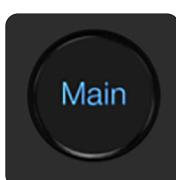
**Control de altavoz (botón "Main")** - Al pulsar el botón "Main", el knob pasará a controlar el nivel de salida principal. Este es el modo por defecto del knob y cualquier otro modo, que no sea Control de auriculares, se desactivará y volverá a Control de monitores.
