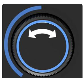
**Posición iluminada del knob** - El anillo iluminado alrededor del knob muestra la posición relativa del knob y cambia de color dependiendo del modo activo. Muestra la posición relativa actual del knob para la salida principal, la ganancia o el nivel de auriculares.
