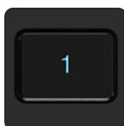
**Botones de selección de canal** - Para controlar el nivel de ganancia de un canal específico, pulse el botón de selección de canal deseado. Pulse de nuevo el botón de selección de canal o los botones Principal o de auriculares para salir del modo Edición de canal.
