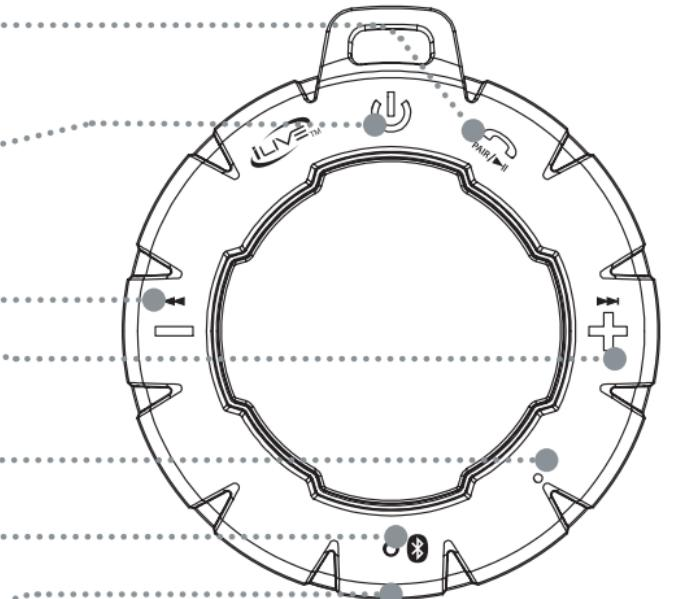
**IMPORTANTE:** Para asegurarse de que su altavoz está preparado para su uso en un ambiente húmedo, desconecte y retire cualquier cable de corriente y cierre firmemente la tapa de agua del puerto de carga. Si la tapa de agua no está correctamente cerrada, la resistencia al agua se verá comprometida y podría dar como resultado daños en los altavoces o lesiones personales.
