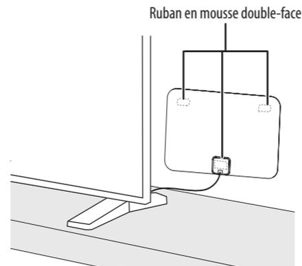
**3** Connecter une extrémité du câble coaxial de l'antenne sur le téléviseur, le convertisseur numérique ou le décodeur :
