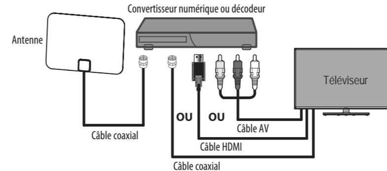
**4** Mettre le téléviseur en marche, puis appuyer sur le bouton entrée (Input) ou Source du téléviseur pour sélectionner l'entrée à laquelle l'antenne est connectée.
